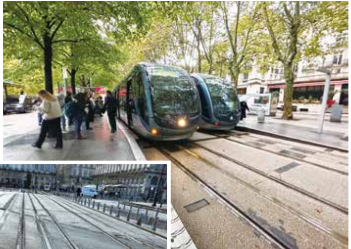
歴史的な中心地区にあるトラムの大ターミナル、カンコンス広場。A線を除く3路線が集結する。地表面から集電するシステム(APS)により、空中に架線は張られていない 2023年11月3日
